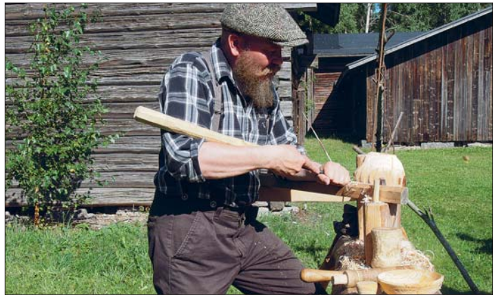
Riku Pasanen työn ääressä. Jalka käyttöinen poljettava sorvi.
